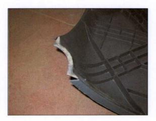
Durante la prova a schiacciamento l'elemento è stato bloccato ai vertici mediante piastre metalliche.
