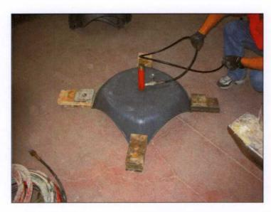
Il carico è stato applicato da un martinetto di area a spinta pari a 7,1  $cm^2$ , da una pompa a mano e manometro. La forza massima applicata è stata di  $150 \ daN$ .
