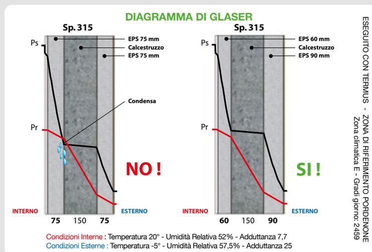
Diagramma di Glaser realizzato su pareti di spessore uguale con diversa distribuzione dell'isolante.
